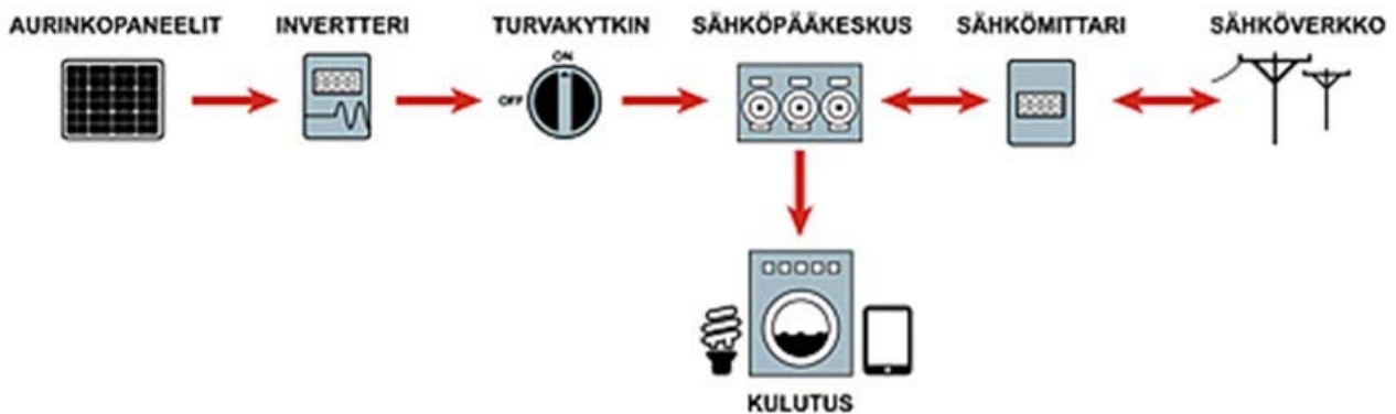
Kuva 2. Verkkoon kytketyn pientalon aurinkosähköjärjestelmän kokoonpano
