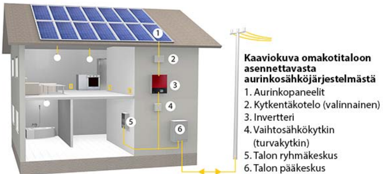
Kuva 1. Periaatekuva yleisen jakeluverkon rinnalla toimivasta aurinkovoimalasta.
